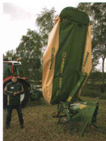
Easy Cut R320, con 5 discos y 2 tambores de siega, ofrece una anchura de corte de 3.14 m.
