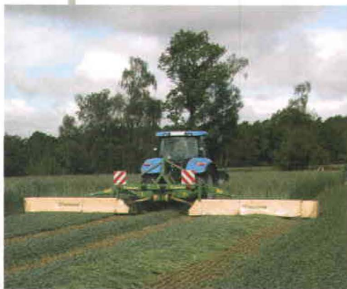
Easy Cut R360 llega a los 3,57 m de anchura de corte con 4 discos y 4 tambores de siega.
