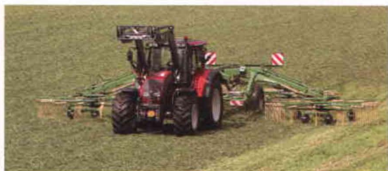
El rastrillo hilerador Swadro 1400 Plus, con cuatro rotores, supone una valiosa alternativa para terrenos de grandes dimensiones.
