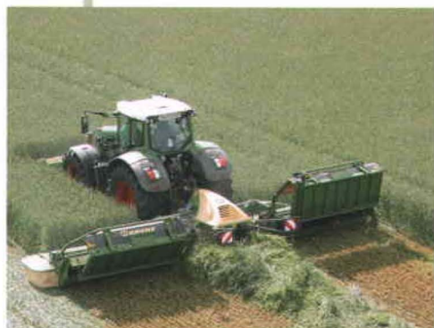
F320 CV + B1000 CV, hasta 10 m de anchura de corte con acondicionador.
