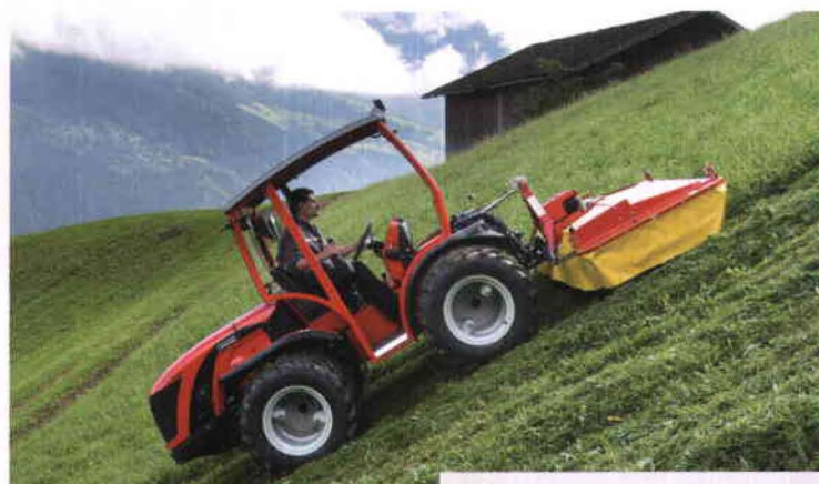
Figura 10. Tractor Antonio Carraro con segadora trasera y puesto de conducción reversible.
