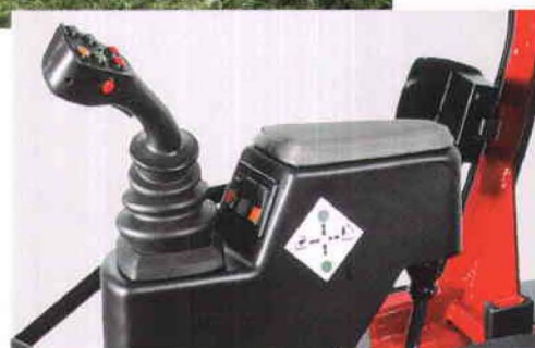
Figura 11. Joystick de los tractores Antonio Carraro.
