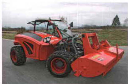
Figura 1. Tractor Sauerburger Grip 4 con cabina descentrada.
