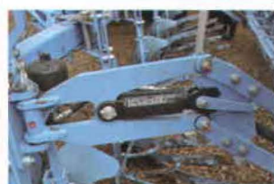
Cilindro hidráulico para elevación y acoplamiento de rodillo lateral.
