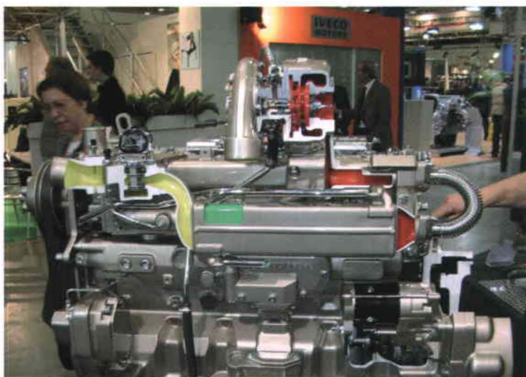
FIGURA 2.- MOTOR CON TURBO DE GEOMETRÍA VARIABLE Y RECIRCULACIÓN DE LOS GASES DE ESCAPE
