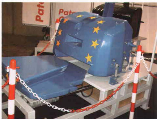
Lastre móvil aplicable a los elevadores delantero y trasero.
