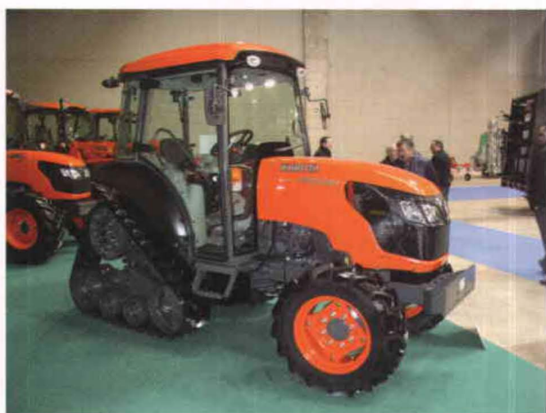
Tractor Kubota Power Krawler, de 85 CV, con propulsión por bandas de goma en el eje trasero.
