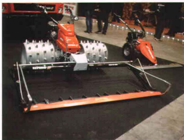
Motosegadora hidrostática Reform, con ruedas metálicas para trabajo en terrenos con fuertes pendientes.
