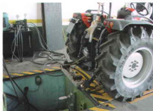
FIGURA 1.- INSTALACIÓN PARA EL ENSAYO DEL SISTEMA HIDRÁULICO DE TRACTORES AGRÍCOLAS (EMA-MADRID)
