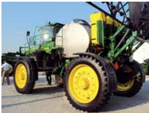
Pulverizador John Deere 4940 de inyección directa.
