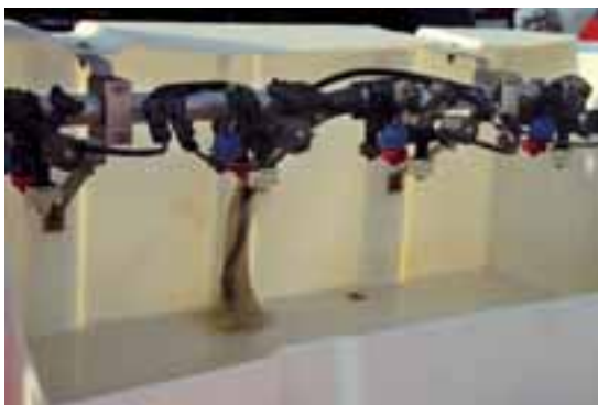
Boquillas pulsantes del pulverizador Case IH.
