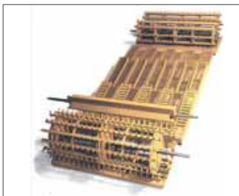
FIGURA 12.- SISTEMA DE TRILLA CON DEDOS Y SEPARACIÓN MEDIANTE SACUDIDORES CON BATIDOR DE DIENTES PARA RECUPERACIÓN DEL GRANO DISEÑADO PARA ARROZ (LOVA)
