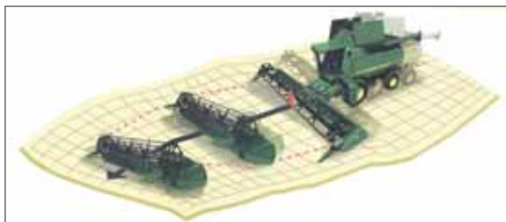
FIGURA 4.- AJUSTE AUTOMÁTICO DE LA ALTURA Y DE LA INCLINACIÓN LATERAL DEL CABEZAL (JOHN DEERE)
