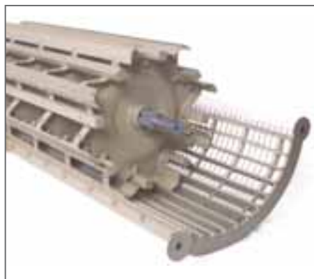
FIGURA 7.- CILINDRO CON 8 BARRAS TRILLADORAS Y 8 DE INERCIA; CÓNCAVO CON 12 BARRAS (LAVERDA)
