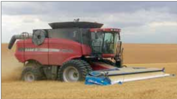
FIGURA 10.- COSECHADORA CON CABEZAL 'STRIPPER' SOBRE TRIGO
