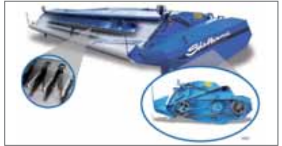
FIGURA 9.- CABEZAL 'STRIPPER' PARA ARROZ
