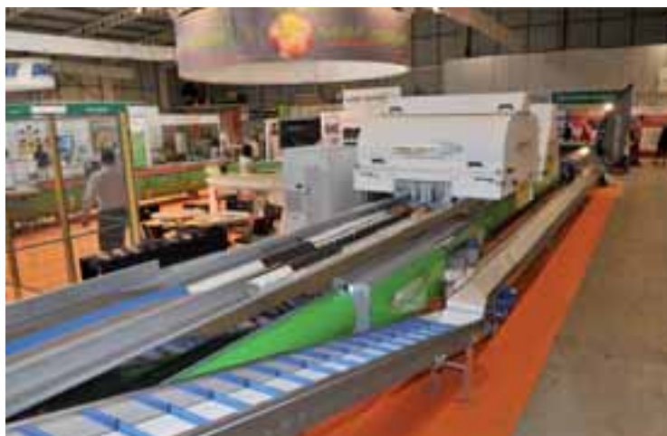
Sistema para la detección y retirada de fruta blanda.
