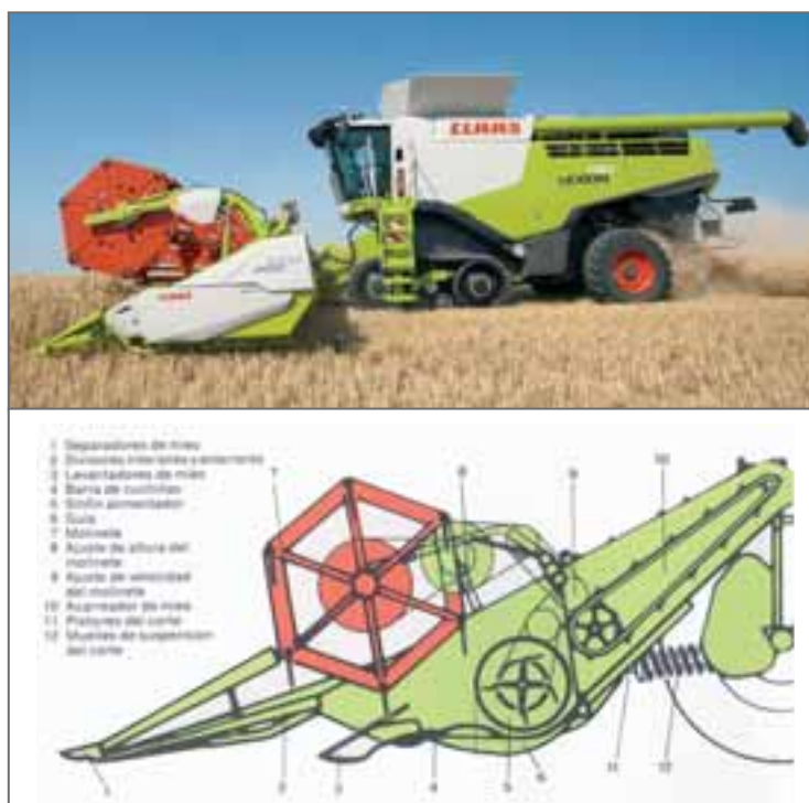
FIGURA 1.- CABEZAL DE LA COSECHADORA (PLATAFORMA CON BARRA DE CORTE, MOLINETE Y SIN-FIN EMBOCADOR)
