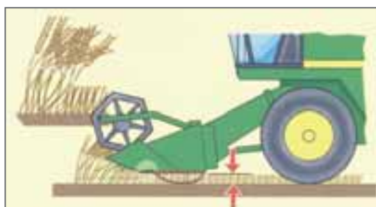
FIGURA 4.- AJUSTE DE LA ALTURA DE LA PLATAFORMA AL ESTADO DEL CULTIVO
