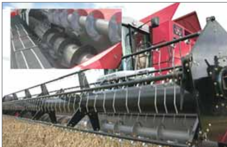
FIGURA 6.- CARRERA DE LAS CUCHILLAS Y SISTEMA DE ACCIONAMIENTO LATERAL
