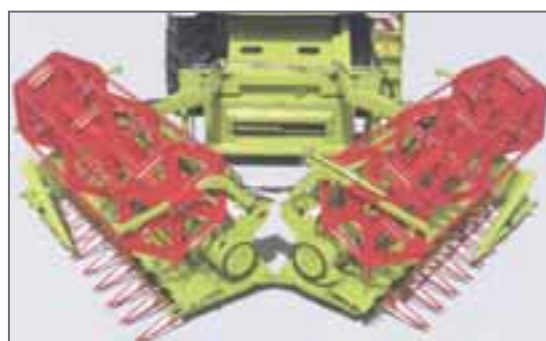
FIGURA 11.- PLEGADO DEL CABEZAL PARA EL TRANSPORTE
