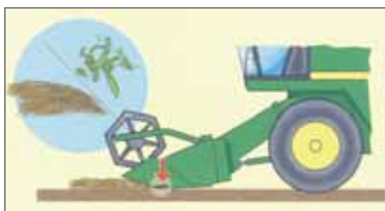
FIGURA 4.- AJUSTE DE LA ALTURA DE LA PLATAFORMA AL ESTADO DEL CULTIVO
