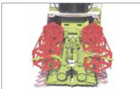
FIGURA 11.- PLEGADO DEL CABEZAL PARA EL TRANSPORTE
