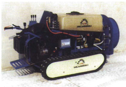
FIGURA 3.- VEHICULO AUTOPROPULSADO SOBRE BANDAS DE GOMA PARA TRABAJOS EN LADERA
