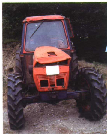
Cabina deformada después de caer por un terraplén y dar varias vueltas de campana, aunque protegió al tractorista.
