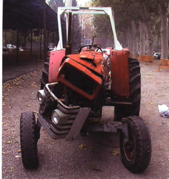
Tractor con estructura de seguridad deformada después de un vuelco lateral.
