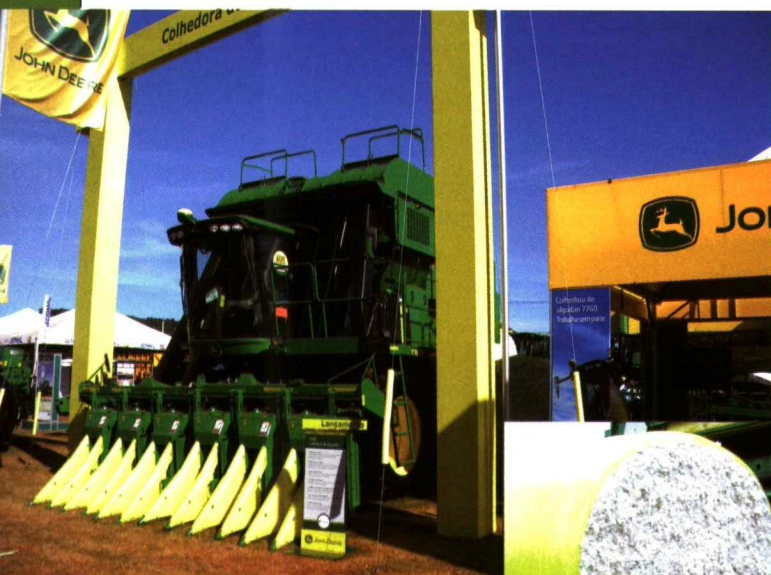
Cosechadora para algodón John Deere 7760 que también empaca la fibra recogida.
