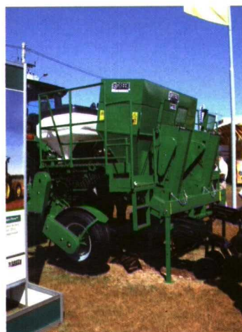
Plantadora de caña Greensystem PP1012.
