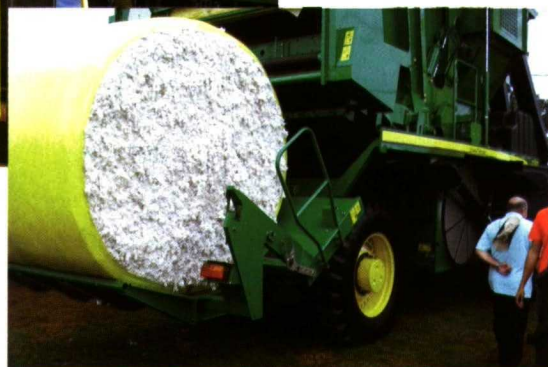
Cosechadora para algodón John Deere 7760 que también empaca la fibra recogida.
