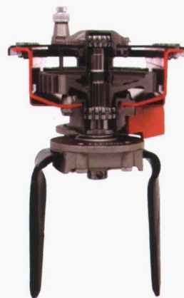
Sistema de soporte, eje, engranaje, sistema de sellado, engranaje con chapón doble HR.
