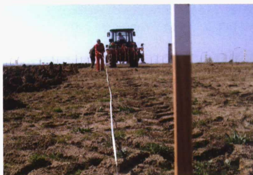
Medida del deslizamiento mediante jalones (5 vueltas de la rueda motriz).
