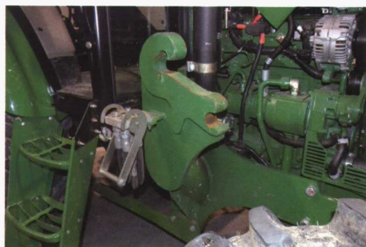
Amarres para el cargador frontal con apoyo en el eje trasero y conexión rápida de hidráulicos.
