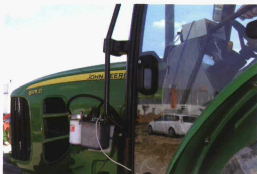
Montaje del caudalímetro.
