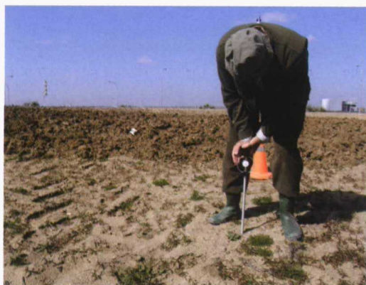
Medida de la resistencia de suelo.
