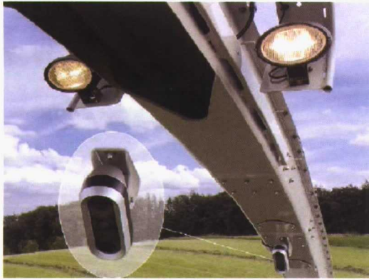
FIGURA 15.- CÁMARA DE VISIÓN 3D SITUADA SOBRE EL TUBO DE DESCARGA
