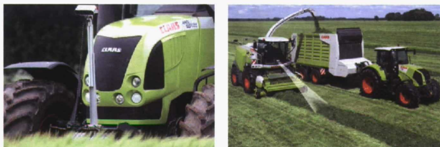
FIGURA 14.- AUTOGUIADO MEDIANTE EL SISTEMA CLAAS CAMPILOT
