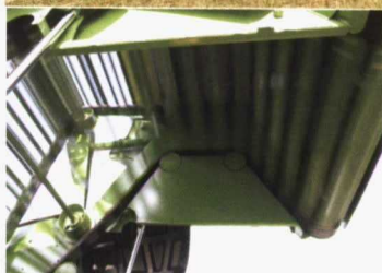
El sistema Novogrip combina correas de goma y barras metálicas.
