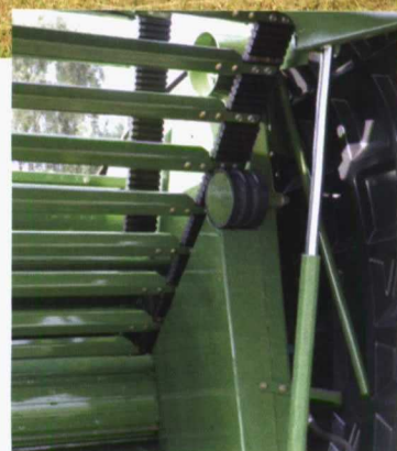
El sistema Novogrip combina correas de goma y barras metálicas.
