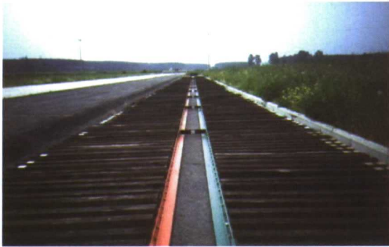
FIGURA 1.- PISTA NORMALIZADA PARA EL ENSAYO DE ASIENTOS SEGÚN ISO 5008 (CNR – TURÍN)
