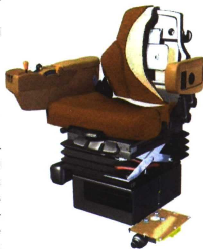
FIGURA 5.- ASIENTO CON SUSPENSIÓN ACTIVA (TRACTORES JD SERIE 8030)
