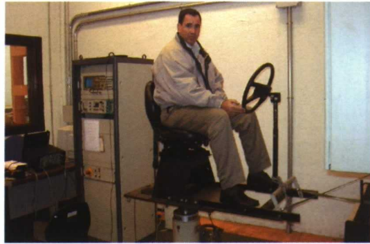
FIGURA 2.- SIMULADOR DE VIBRACIONES PARA ASIENTOS (EMA – MADRID)
