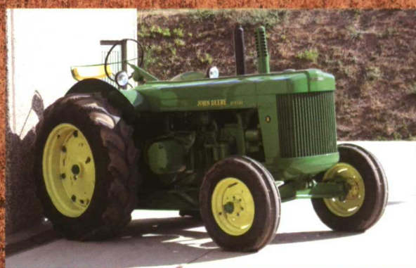
John Deere modelo R, de 1954, que incorpora un motor boxer de gasolina para arrancar su motor de dos cilindros diésel de 6 800 cm 3 a modo de motor de arranque.
