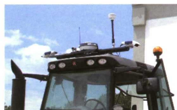
Sensor de vegetación sobre el techo del tractor.
