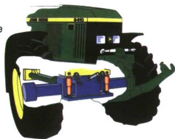
Suspensión primaria en el eje delantero.
