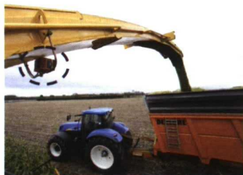
Análisis de imagen que guía la descarga.
