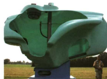
Diseño del depósito para minimizar el volumen residual.
