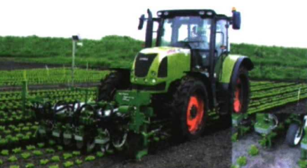
Robot para escarda mecánica (Garford).
