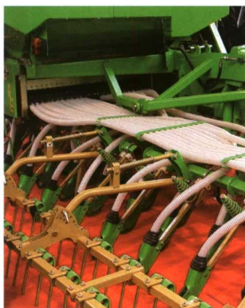
Dosificación individualizada y transporte mediante corriente de aire.
