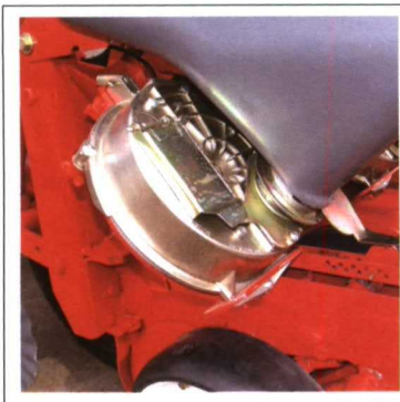
Dosificador de plato inclinado y placa para soja.
