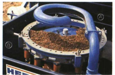
Dosificador mecánico central con transporte neumático de la semilla.
