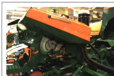
Dosificador centralizado para siembra monograno.
