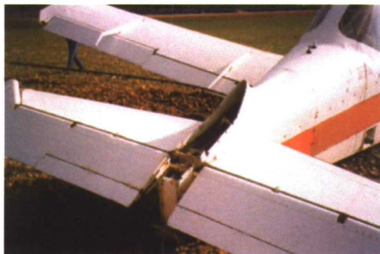
Pérdida de la cola en choque con cable eléctrico (Ciudad Real).
