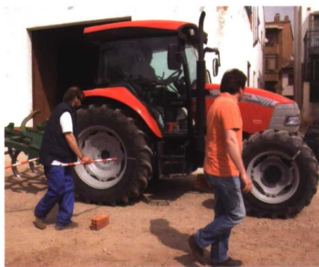
Procedimiento para determinar el adelanto del eje delantero.
