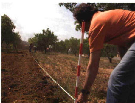
Se realizaron varias pasadas para conocer los valores del porcentaje de resbalamiento con un cultivador de 11 brazos y 3.2 m de anchura.
