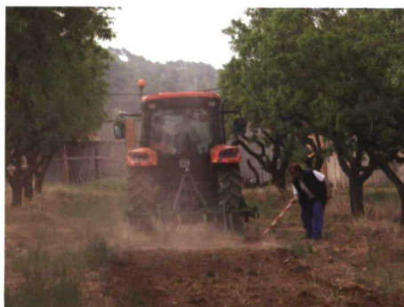
Se realizaron varias pasadas para conocer los valores del porcentaje de resbalamiento con un cultivador de 11 brazos y 3.2 m de anchura.
