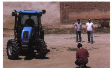
Recogida de datos para obtener el radio de giro del 5H-110 (imagen superior), del Alpine 85 (inferior izquierda) y del Rex 90.
