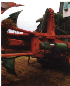
En las imágenes inferiores se aprecia cómo el arado corrige la pasada y recupera la línea recta. A la izquierda se observa el cilindro que ajusta la anchura de trabajo y compensa el desvío.
