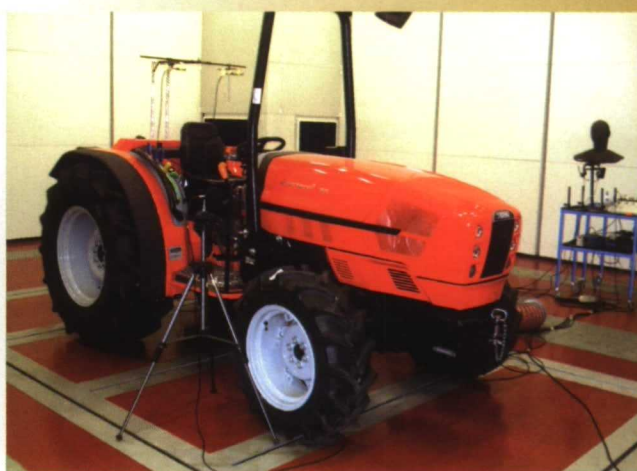
Medida del nivel sonoro en cámara semi-anechoica.
