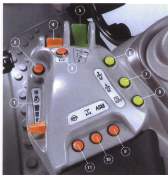
FIGURA 4.- Conjunto de controles en el apoyabrazos derecho del tractor Agrofarm 430 TTV
