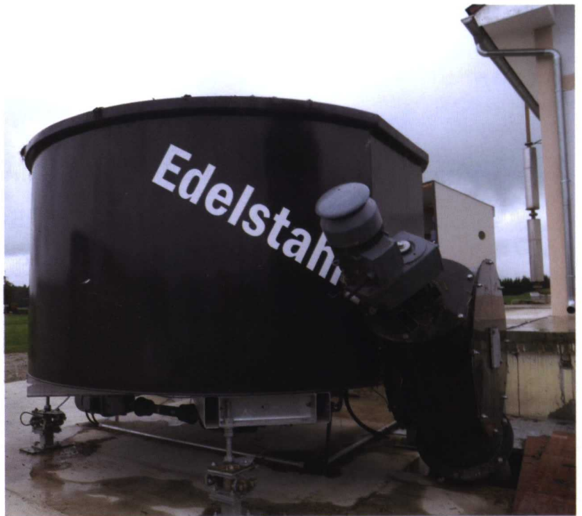
Alimentador de acero inoxidable, con base de polietileno, con una capacidad de 32 m 3 y sistema de empuje.
