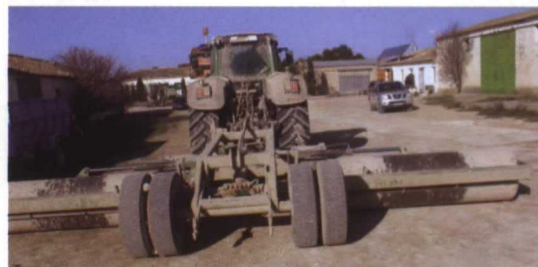
El empresario agrícola es capaz de fabricarse algunos implementos, como este rodillo de 9 m de anchura.
