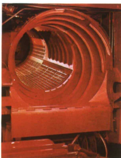
Entrada de la mies a la cámara del rotor en la 'Axial Flow'.
