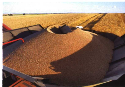
La capacidad de la tolva para grano alcanza los 10580 L.
