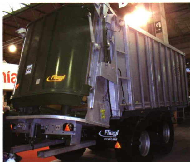
Una de las características distintivas de los remolques Fliegl es el sistema de empuje patentado por la marca.
