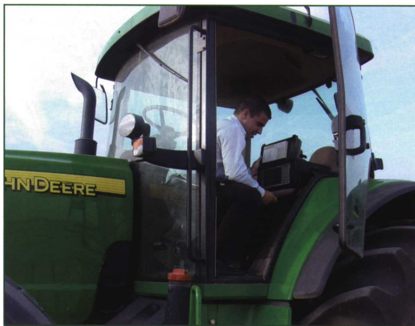
FIGURA 7.- MEDIDA DE LAS VIBRACIONES EN CAMPO CON UN ANALIZADOR DE DOS CANALES
