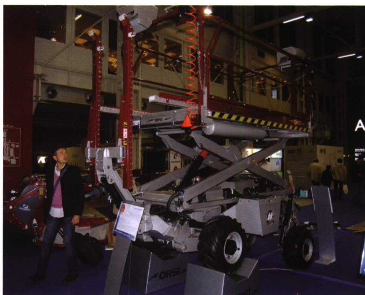
Grupo Orsi: Plataforma autonivelante y polivalente para la recogida de fruta.
