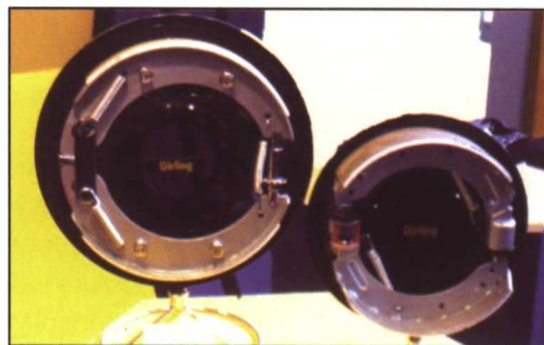
FIGURA 4.- FRENOS DE ZAPATA CON DIFERENTES SISTEMAS DE ACCIONAMIENTO Y FIJACIÓN
