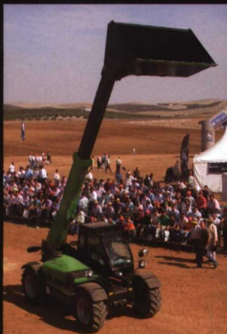
Cargadora telescópica Agrovector 35.7, con una capacidad máxima de elevación de 3 500 kg y una altura máxima de 7 m.
