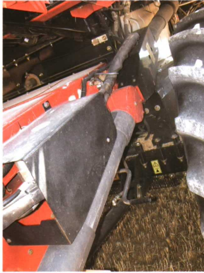
La transmisión desde la garganta hasta el corte es mediante cardan.
