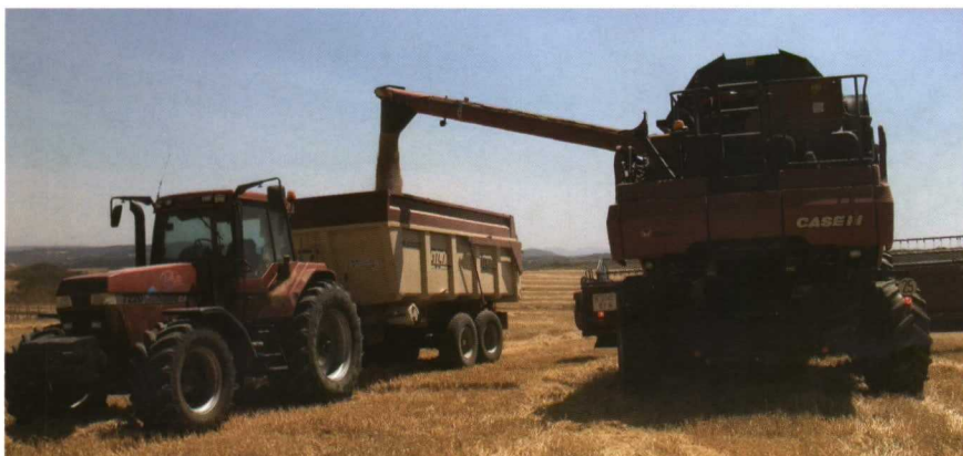
En apenas 90 segundos realiza la descarga completa del cereal cosechado.
