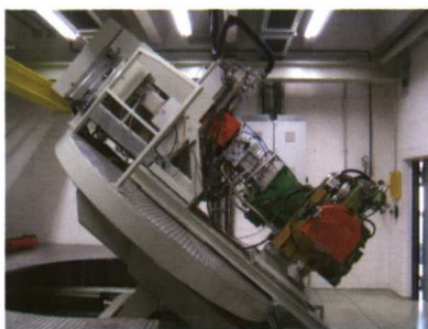
El conjunto motor-transmisión se prueba en diferentes planos de inclinación.
