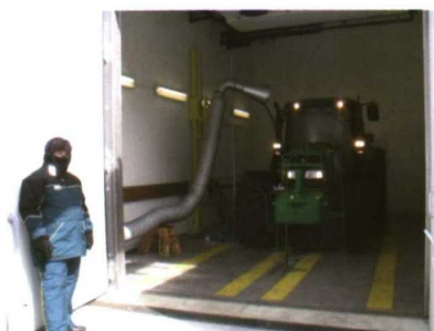
En esta sala se somete al tractor a temperaturas extremas.
