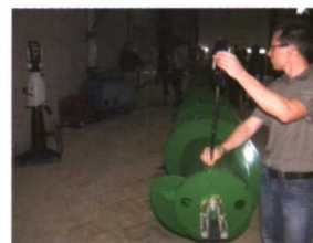
El sistema Leica Tracker utiliza una cámara y un reflector móvil para detectar posibles errores sin necesidad de desmontar la pieza.
