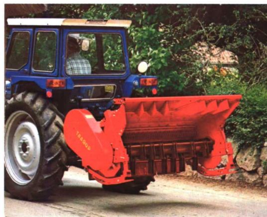
Trituradora de eje horizontal con cuchillas para paja.
