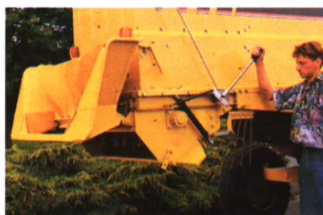
Retirada del esparcidor.
