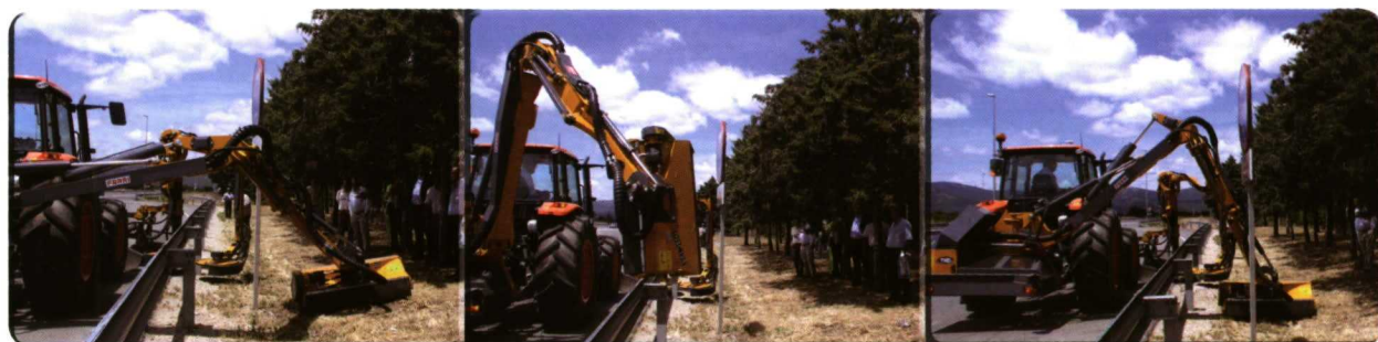
El brazo dispone de un sistema que le permite sortear obstáculos de tipo vertical.
