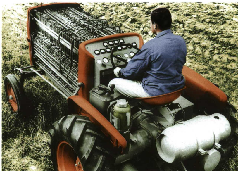
En 1959, Allis-Chalmers desarrolló un tractor (modelo D12) que utilizaba pilas de combustible con una capacidad de generar 15 kW de potencia (foto AGCO Corporation).
