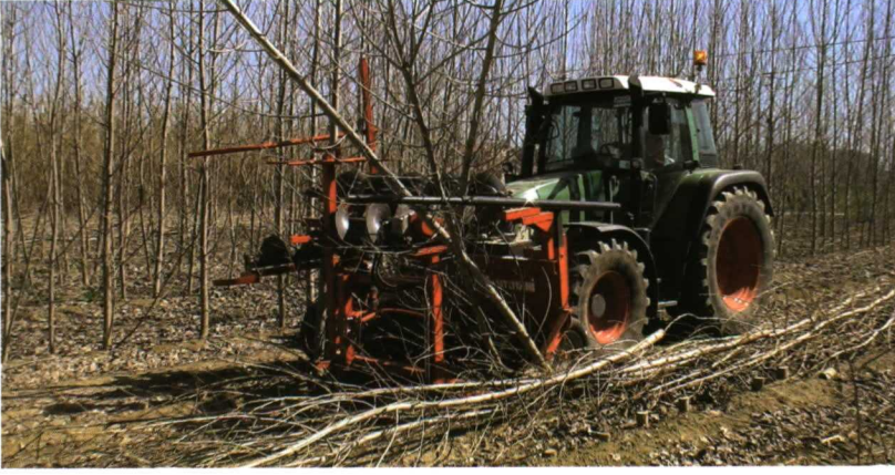
Segadora-alineadora trabajando sobre chopo (foto L. Pari).
