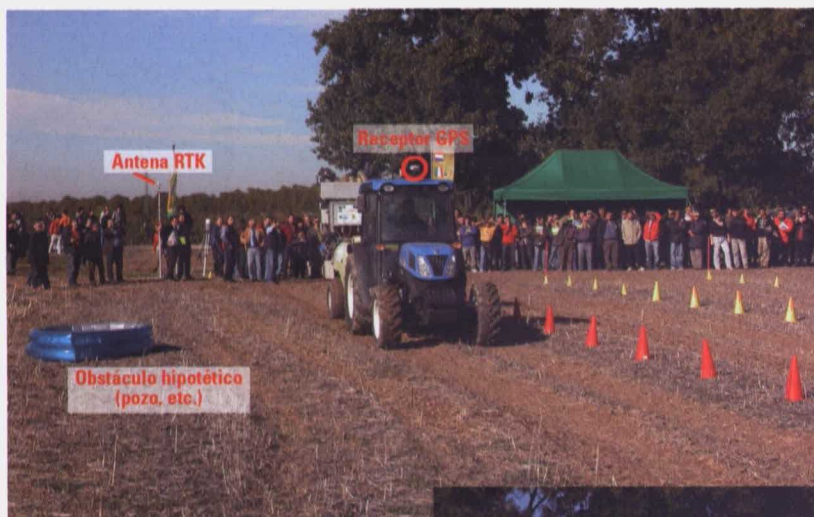
El sistema EDAS ajusta la aplicación a la posición de la parcela y la presencia de puntos críticos, considerando también las condiciones ambientales.
