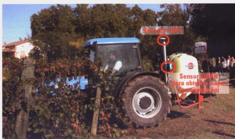
La cantidad de producto aplicada se modifica continuamente según la densidad o el volumen de aplicación.
