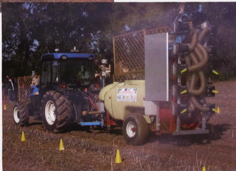
El sistema CIS adapta el tratamiento a las características de la vegetación. Durante la demostración, la pulverización se ajustaba o incluso interrumpía al paso de la máquina junto a los paneles que hacían las veces de vegetación.
