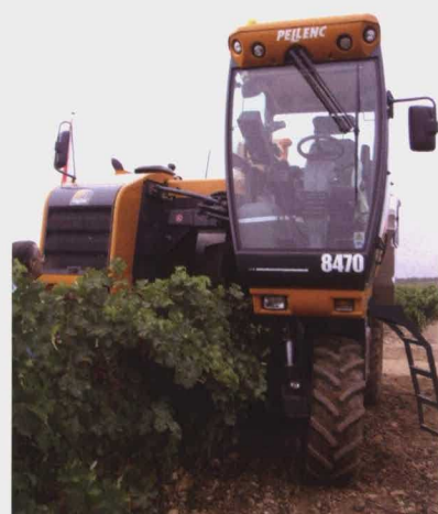
Detalle de la cabina insonorizada de la vendimiadora autopropulsada Pellenc 8470.
