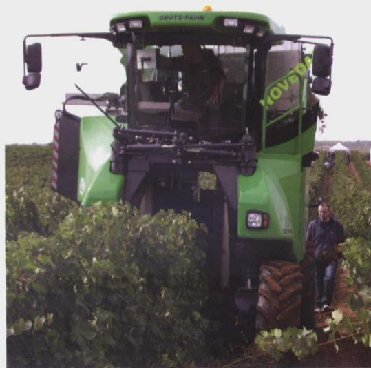
Vendimiadora Deutz-Fahr Agrovitis 200, con cabina centrada.
