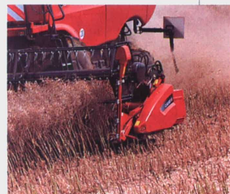
Hay disponibles cuchillas eléctricas para la cosecha de la colza.
