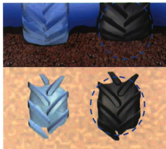
A la derecha, Michelin OmniBib serie 70 (círculo azul punteado) presenta una superficie de huella más ancha que su primer competidor gracias a su carcasa flexible y a una presión de inflado un 12% inferior. Las presiones sobre el suelo se reparten mejor en toda la superficie de contacto.
