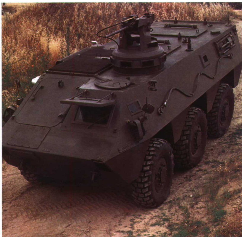
Vehículo militar BMR de seis ruedas con suspensión independiente.
