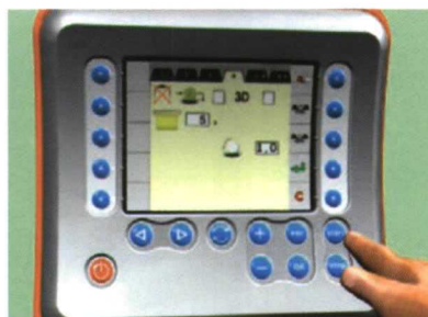
1. Elección del número de capas a aplicar (en este caso son cinco).
