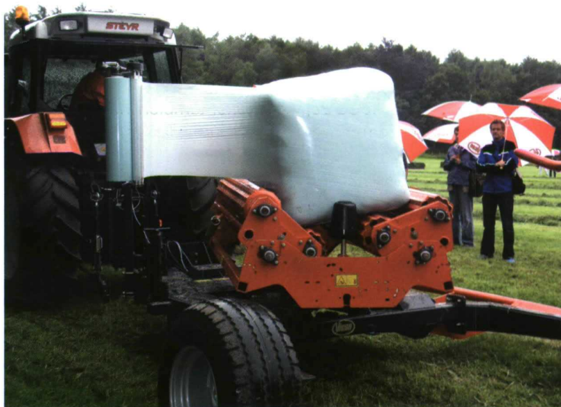
4. Se aplican dos capas más con un 50% de solapado.
