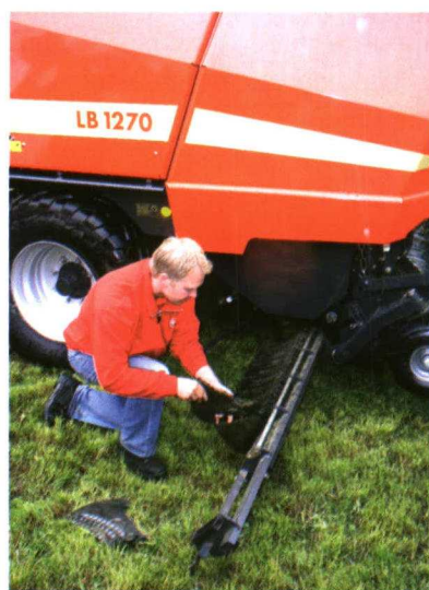
Un sistema hidráulico que desplaza al exterior el bastidor facilita el cambio rápido de las cuchillas del picador.
