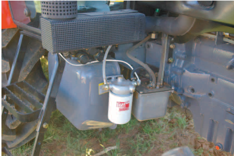
Montaje del caudalímetro.
