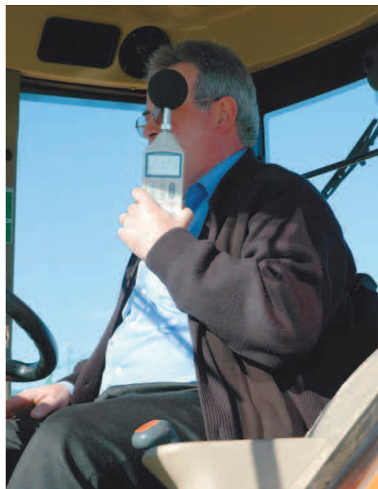
Medida del nivel de ruido.
