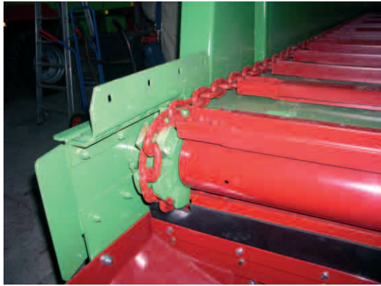
El espesor de las piezas utilizadas en el montaje de los remolques es de 6 mm
