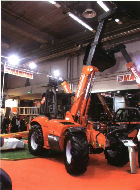
El nuevo Manitrac 728 alcanza los 6.80 m de altura con una capacidad de elevación de 2 800 kg.
